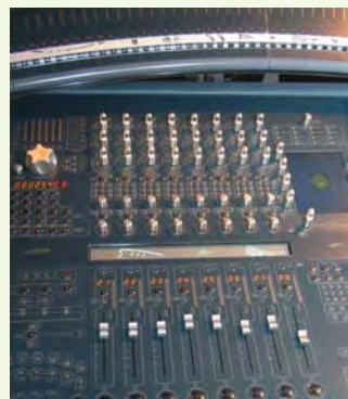
Zentrale Bodeneinheit des SmartAV – sogar die Beschriftung der Kanäle wird mit aufgerufen
