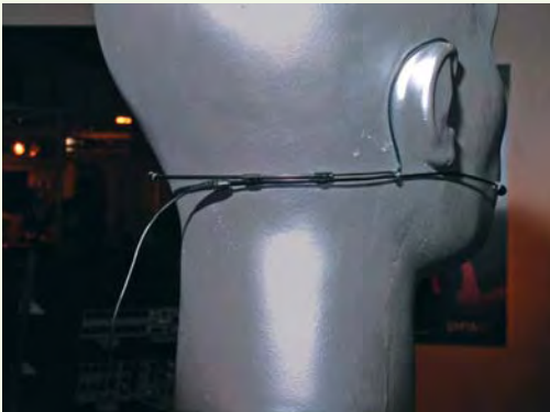
DPA-Kopfbügelmikrofon mit verstellbarem Nacken- und Mikrofonbügel
