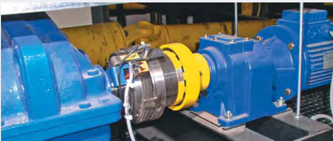
Magetkupplung zwischen Haupt- (links) und Notantriebsmotor (rechts)
