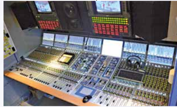
Das im Ü-Wagen von TopVision eingebaute AURUS-Tonmischpult von Salzburg Stagetec
