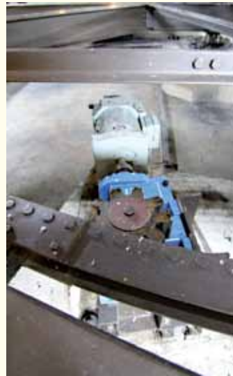
Der alte Drehbühnen-Antrieb
