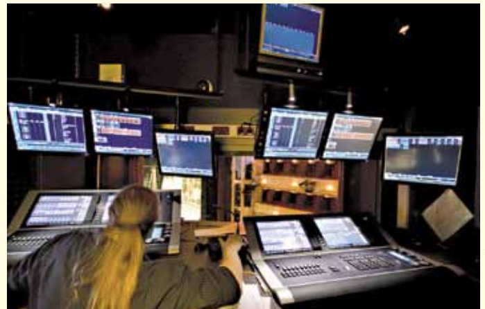
Ganz oben rechts die RPU mit Monitor, darunter die beiden EOS-Pulte mit je 3 Monitoren
