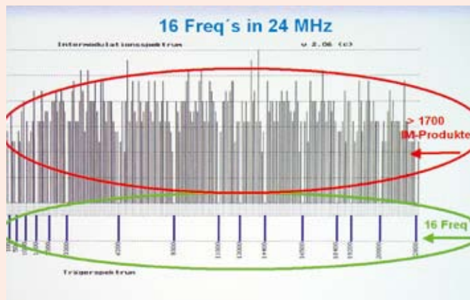
Aus nur 16 Frequenzen entstehen 1.700 Intermodulationsfrequenzen
