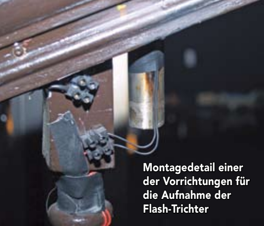
Flash-Trichter, gefüllt mit Lycopodium, wie er am Ende der Stiege und im Kronleuchter eingesetzt wird
