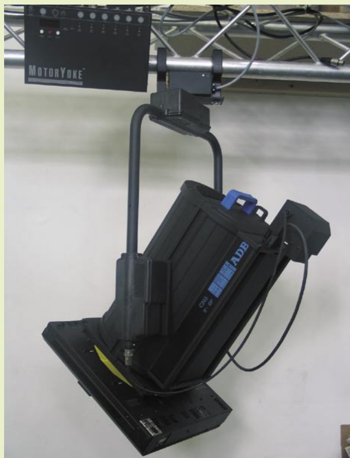
Die neue Antriebseinheit MY 2 für PAN und TILT
