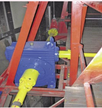
Schneckengetriebe und Gelenkwellen für den Antrieb der Zahnritzeln
