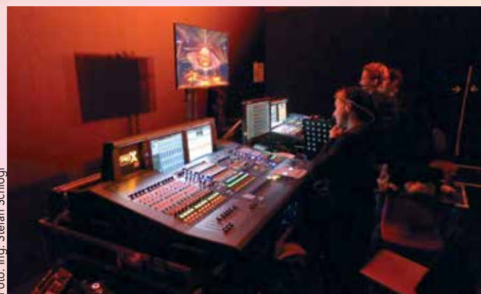
Auf den MIDAS PRO X-Pulten erfolgte das Mischen des Bühnenmonitoring
