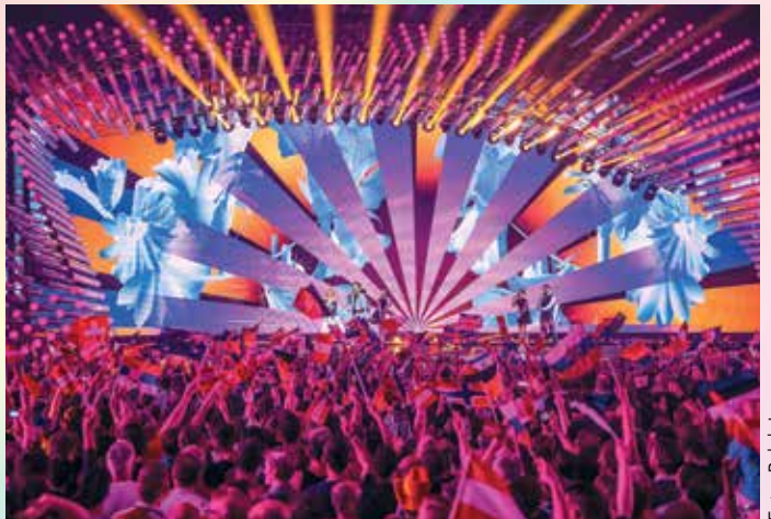
Die Moving-Heads „Mythos“ gemischt mit „Stormy“-Leuchten und „Sharp Wash“ im Bühnenhintergrund unterhalb der LED-Wand
