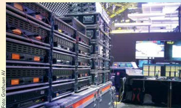
Die Sennheiser-Funkgeräte für das Mikrofon- und InEar-System
