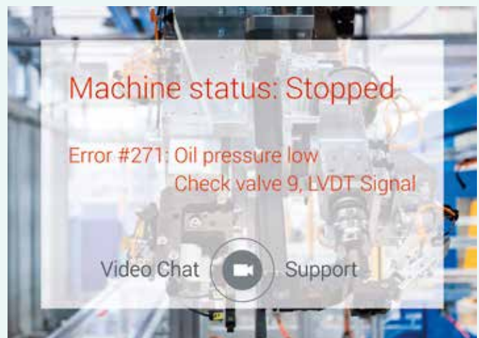
Bei einem Maschinenfehler vibriert die Datenbrille kurz und macht den Träger so auf die zugehörige Fehlermeldung aufmerksam. Ist der Fehler behoben, lässt sich die Meldung direkt über die Brille zurücksetzen
