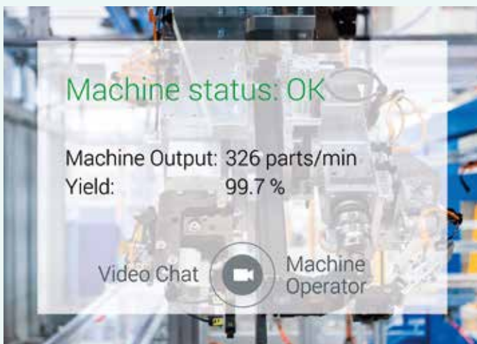
Mit der Datenbrille lassen sich nicht nur statische Informationen, sondern auch dynamische Werte zum Maschinenstatus ins Blickfeld einblenden
