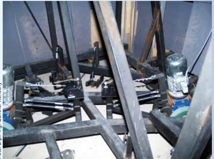
Reibradantrieb und Stützräder – deutlich zu erkennen die Gas-Anpressfedern
