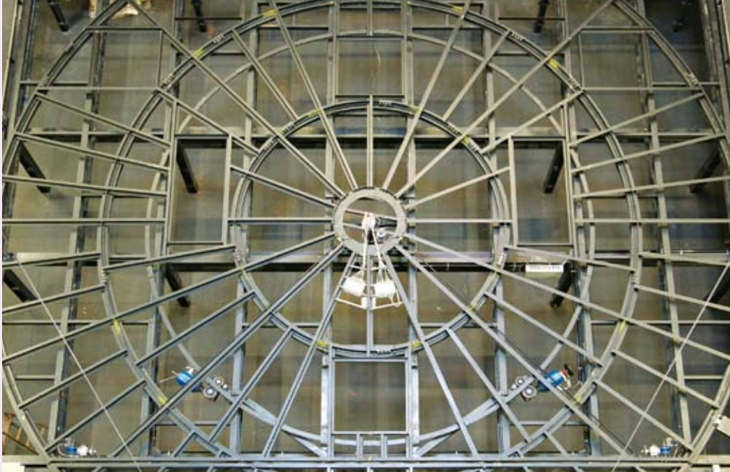
Die beiden blauen Reibradmotoren bewegen die Drehbühne
