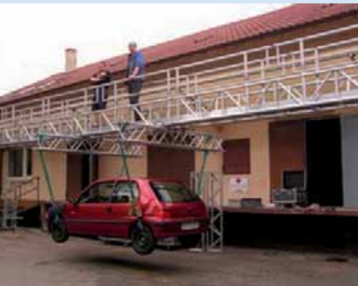
Die Laufstegtraverse im Belastungstest
