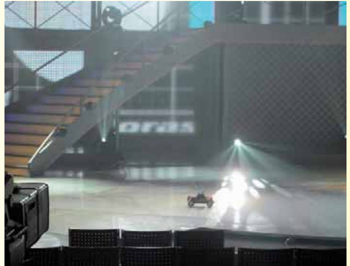
Im ORF wurde im Studio Z1 sogar ein schnelles, ferngesteuertes Modellauto mit einem Transponder versehen, um zu zeigen, mit welcher Geschwindigkeit die Scheinwerfer zu folgen vermögen
