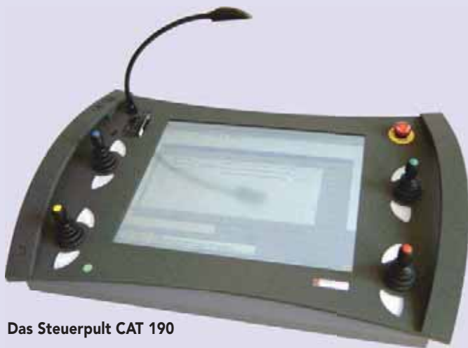
Das Steuerpult CAT 192 mit 2 Fahrhebeln links und rechts
