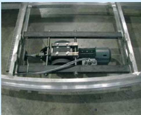
Einer der 5 Reibradantriebe der Drehbühne
