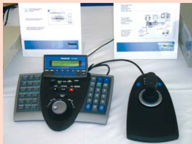
Fernbedienung der Kamera mittels Joystick oder über Tasten
