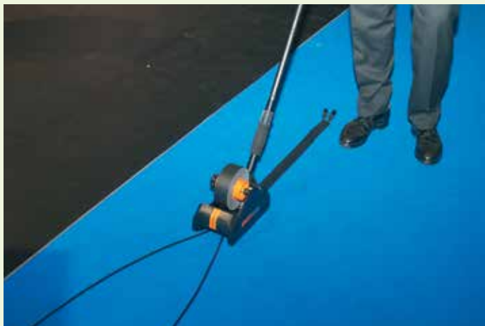
GAFFGUN fasst die Kabel selbst zusammen
