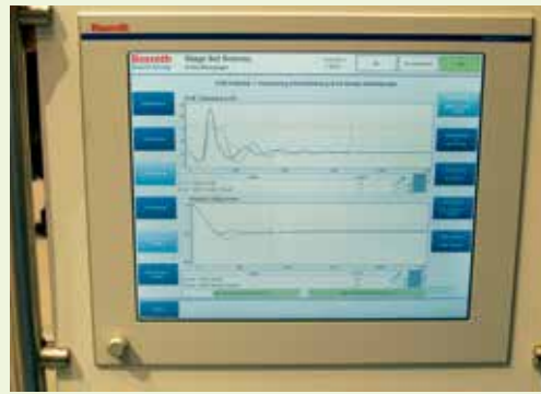
Im oberen Diagramm deutlich zu erkennen: Der Stoßbelastung wird die Spitze genommen
