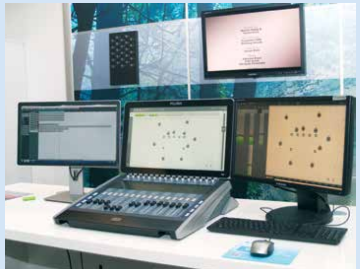
POLARIS evolution: Am Touchscreen können Schallquellen positioniert werden
