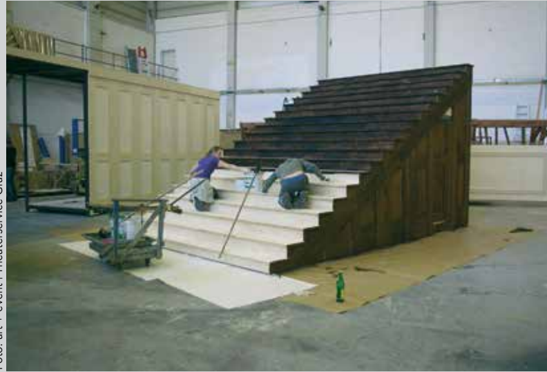
Bau der auf Schienen fahrbaren Treppe, mit der das Wasserbecken abgedeckt werden kann
