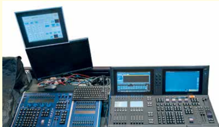
Zur lokalen Visualisierung und als Bedienerschnittstelle nutzt das Kuopio-Stadttheater den Panel-PC CP6602 (im Bild links oben, mit Visualisierung). Die Bedienung kann aber auch via Webservices über ein Smartphone erfolgen
