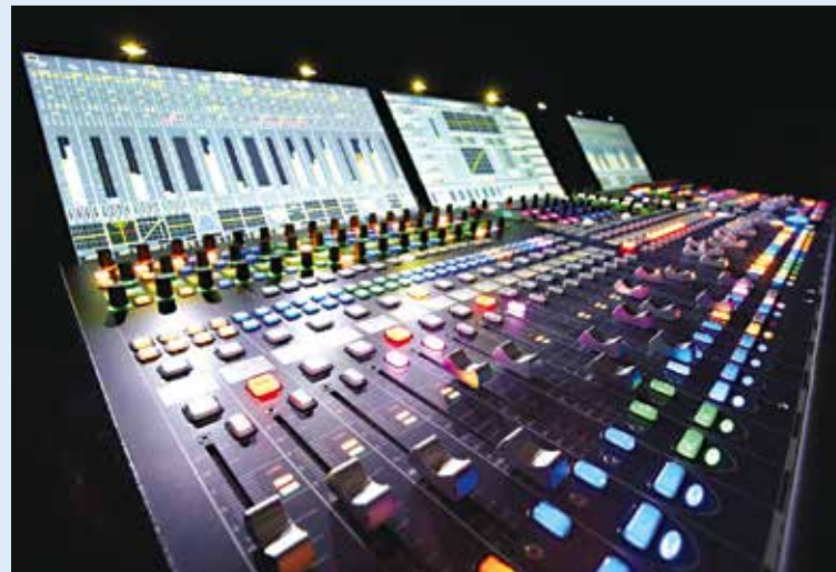
mc 2 56 Mischpult, mit dem LAWO die Spiegelung von Pulten demonstrierte
