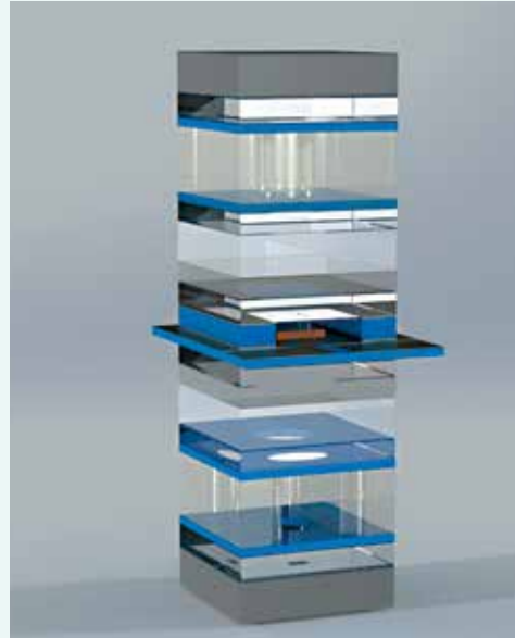
Aufbau eines optischen Mikrofons inklusive Laserdiode (Mitte) und Photodioden (unten und oben). Der miniaturisierte Sensor ist in Glaswafer-Optik-Technologie realisiert und hat eine Grundfläche von 4 x 4 mm.
