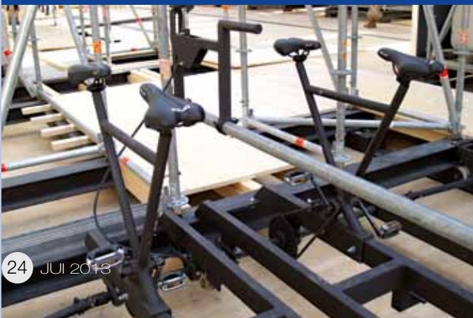
Der bereits eingebaute Antrieb: für jede Fahrtrichtung ist ein Sitz vorgesehen; 2 Personen bewegen die teils 18 Tonnen schweren Kulissen problemlos
