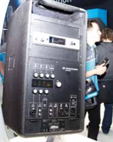
Der LSP 500 PRO kann drei Mikrofonempfänger aufnehmen. Das Ausstellungsgerät war nur mit einem bestückt
