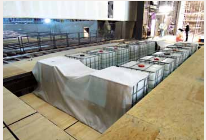
Lasttests der Sekundärpodien mit 125 Prozent Überlast
