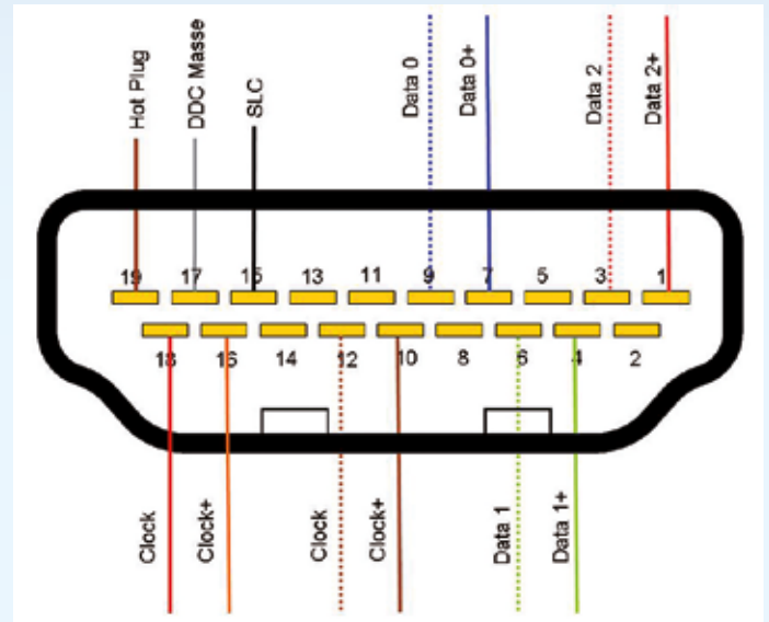
Der HDMI Stecker und seine Belegung
