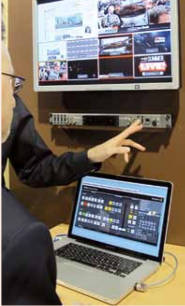
ATEM Videomixer-System: Preview-Anzeige, 19" Hardware, Control Panel (von oben nach unten)
