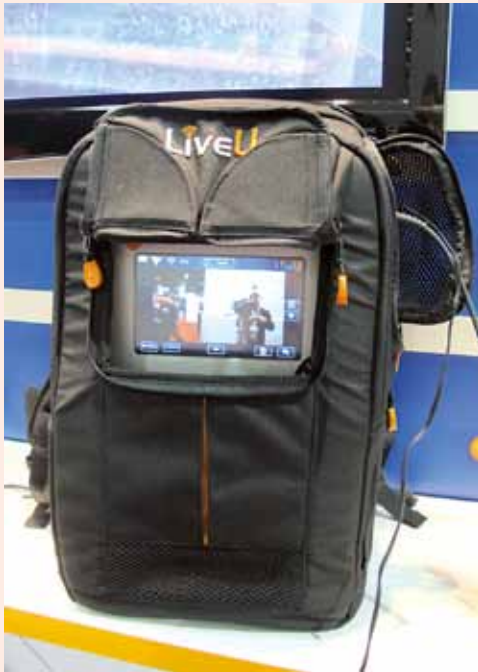
HD Live Streaming via UMTS-Netz ins Internet – Sendestation in Rucksackform
