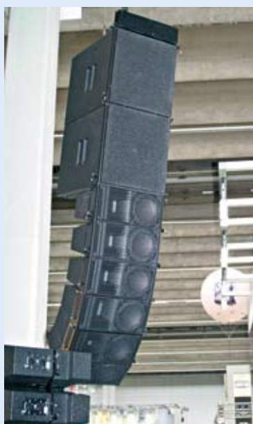
Line Array LR7: Oben zwei LR7B-Flugbässe, darunter LR7-Boxen
