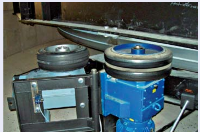
Zusatzantrieb angepresst in Arbeitsposition
