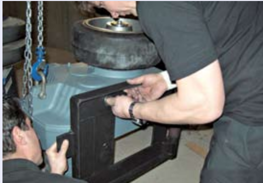
Montage des Klapp-Mechanismus am Zusatzantrieb
