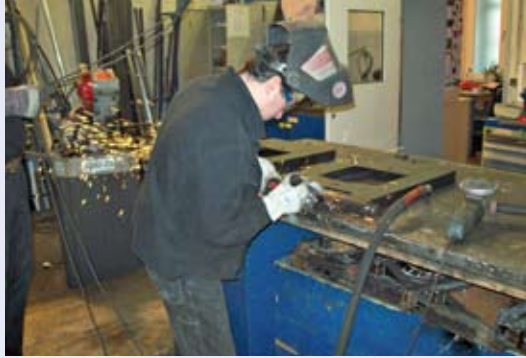
Flexen in Werkstatt – Herstellen des massiven Klapp-Rahmens in der hauseigenen Schlosserei
