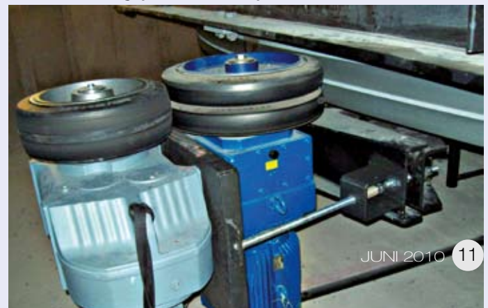
Zusatzantrieb angepresst in Arbeitsposition
