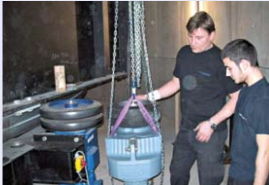
Anpassprobe mit dem Zusatzantrieb
