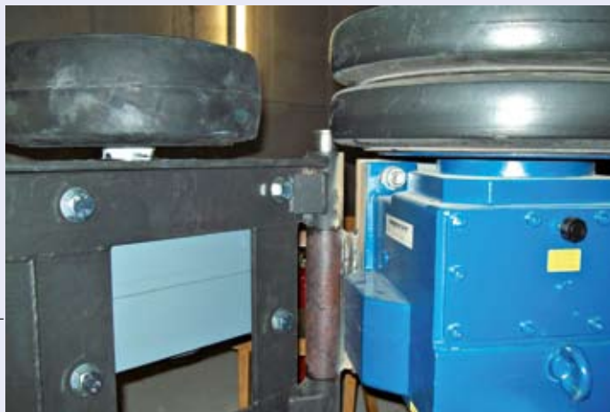
Anpresskontrolle – Detail: Anpressdruckregelung mittels Feder
