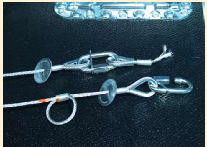
Bei gleicher Last: Das normale Seil riss ab, das Saveking-Seil mit Schlinge hielt problemlos
