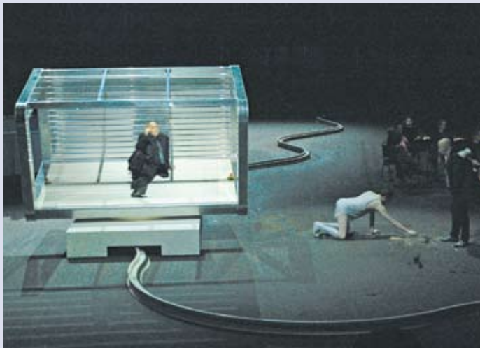
Der Wagen mit 1.400 kg Eigengewicht, der sich in allen Richtungen bewegen lässt
