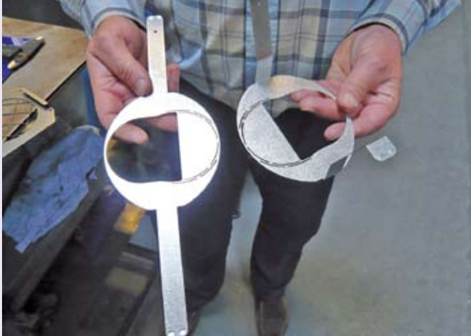
Auch die komplizierten Bleche für die Shutter des „Warp“ werden mit Laser geschnitten
