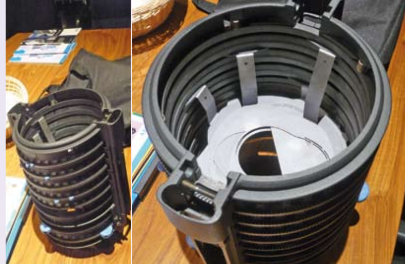
„Warp“-Gehäuse mit bereits eingebauten Shuttern
