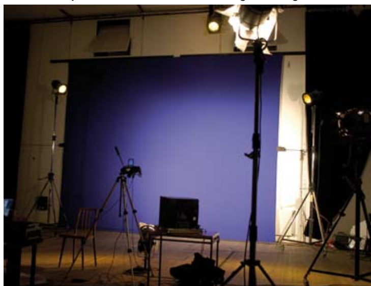
Beim Blue Box-Verfahren wird vor einem blauen Hintergrund aufgezeichnet. Dies erlaubt später das Einblenden eines beliebigen Hintergrundbildes
