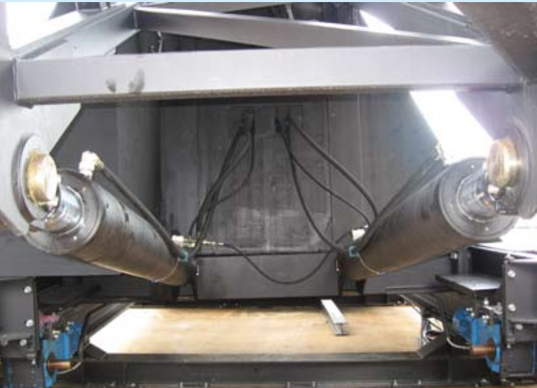
Die beiden Zylinder für die Betätigung des Kranarms der Iris (Durchmesser 250 mm, Hublänge 1760 mm)
