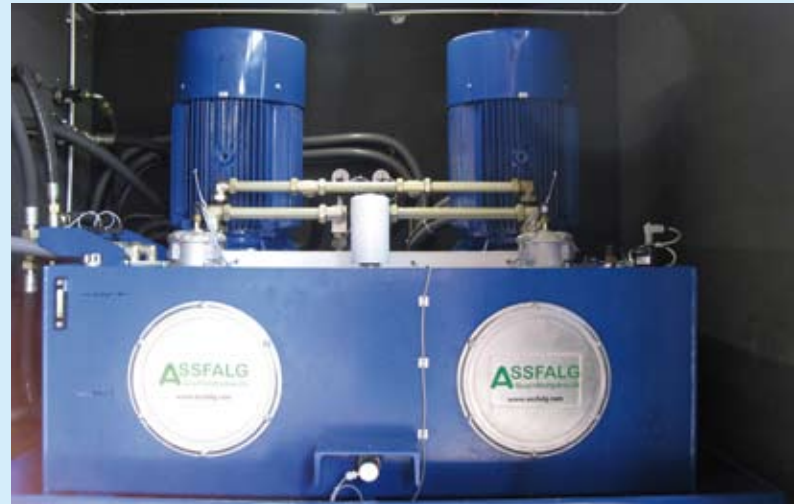
Die 2 x 95 kW Antriebe auf den beiden Innenzahnradpumpen, die den Nenndruck von 160 bar erzeugen
