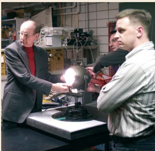
Ermittlung der Lichtstärkeverteilung eines Scheinwerfers
