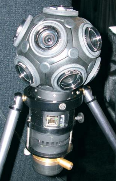
Die Kugel mit 11 Kameras von Immersive Media
