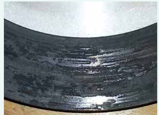
Oberfläche einer thermisch überhitzten (= verglasten) Bremsscheibe
