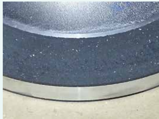
Oberfläche einer fabrikfrischen, noch nicht eingebremsten Bremsscheibe
