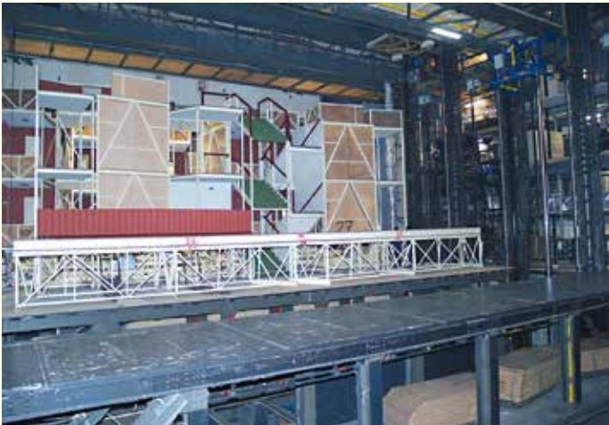
Die vollgeräumte Unterbühne – von hier werden die Elemente mit einem der Hubpodien auf die Bühne transportiert
