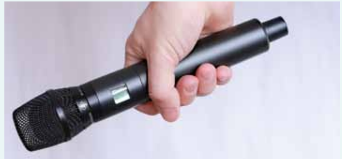
Handsender HH/E01 mit 2 AA-Batterien
