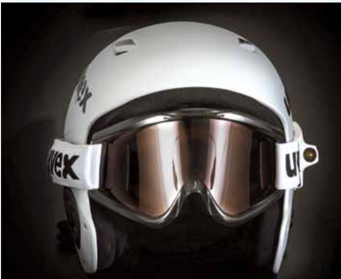
Da sich die Kamera genau in Augenhöhe befindet, ergibt sich die Sicht aus der Perspektive des Rennläufers
