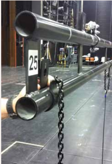
Die offene Schelle wird in den unteren Gurt der Zwei-Gurt-Laststange eingeführt. Auf diese Weise ist ein Weiterrutschen im gesamten System möglich.
