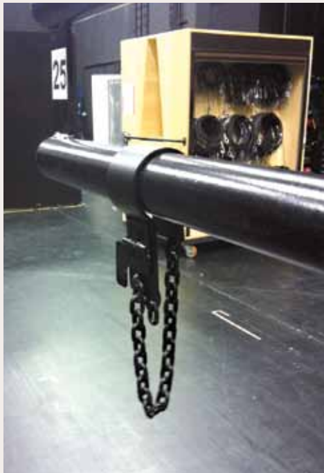
Der Selbstverschluss-Mechanismus ist geschlossen, die Kette hängt frei
