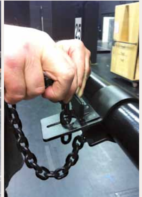
Die Kette kann durch Anheben des Selbstverschluss-Mechanismus durch die Öffnung geführt werden. Die Längenjustierung erfolgt einfach durch die Positionierung der einzelnen Kettenglieder.
