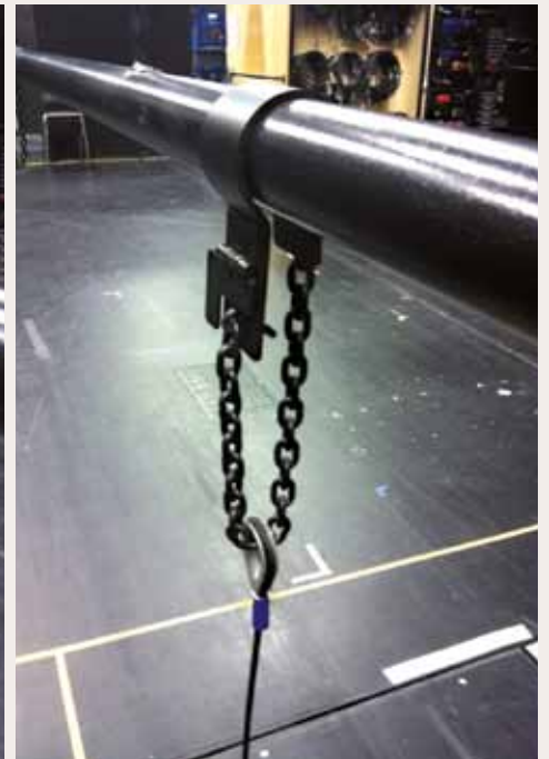
Die Schelle mit eingehängtem Seil/Tragmittel
