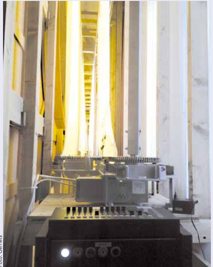
oben: Einblick Technikbereich Crystal Bar links: Antrieb und Umlenkung für das mit den Figuren bedruckte Nesselgewebe
