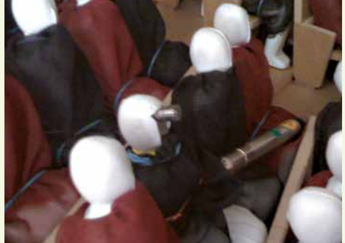
Das kleine Messmikrofon im Kopf einer Puppe
