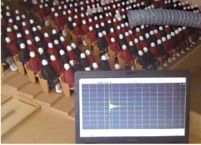
Messung mittels Impuls – Man beachte, dass jeder Sitzplatz durch eine bekleidete Puppe besetzt ist
