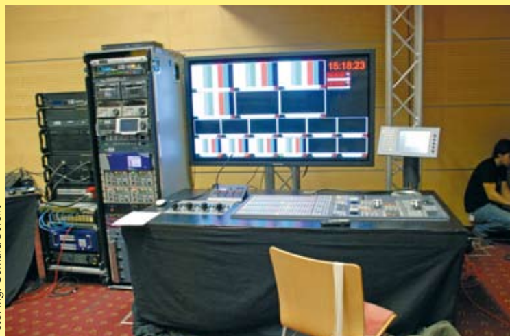
Alle Live-Bilder und MAZ-Zuspieldaten wurden an einem SONY DVS 9000-Videomischpult vorgemischt
