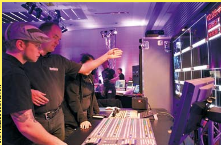
Alle Live-Bilder und MAZ-Zuspieldaten wurden an einem SONY DVS 9000-Videomischpult vorgemischt
