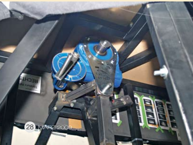
Der manuelle Antrieb durch ein Zahnradgetriebe mit hoher Übersetzung
