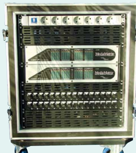
Das Stagerack mit 24 Ein- und 8 Ausgängen in XKR
